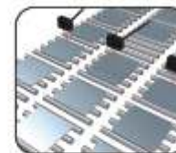
Detección de placas apiladas
